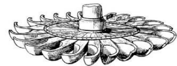
paddle wheel (moulin à cuve)
